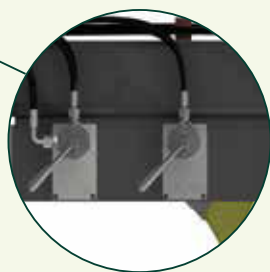
Диверторный кран для переключения гидравлических функций
